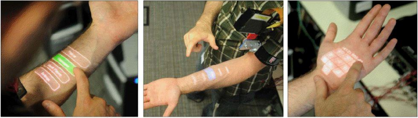
Abbildung 4 – Skinput [2]. Das System bestehend aus dem Armband sowie dem Projektor, welcher das darstellen interaktiver Elemente auf der Haut ermöglicht
